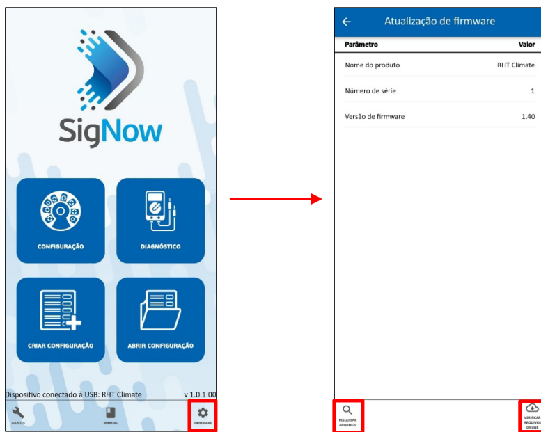
Figura 44 – Atualizando o firmware via aplicativo
